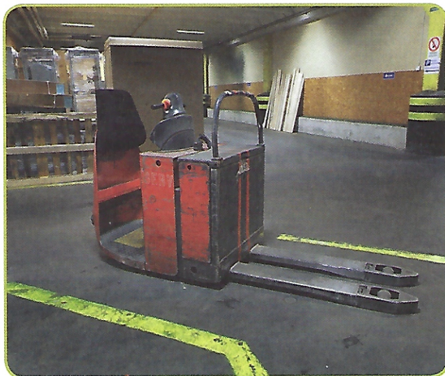
A3: Låglyftande åktruck med plats för stående eller sittande förare
