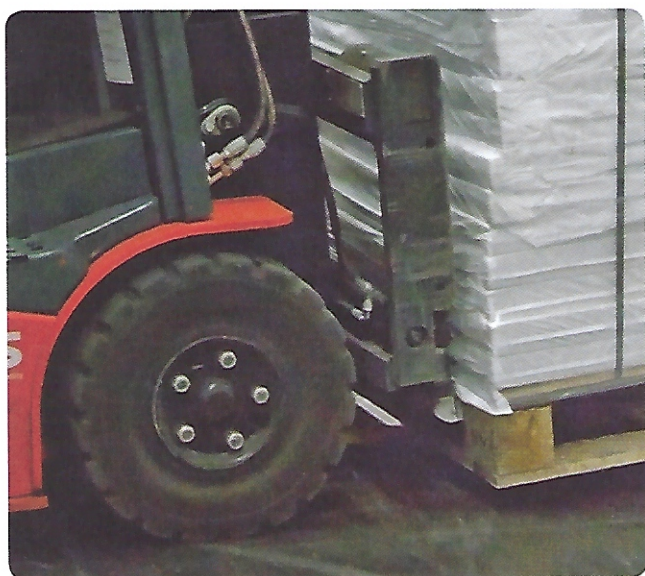
Trucken har stålgaflar som lyfter en träpall.
