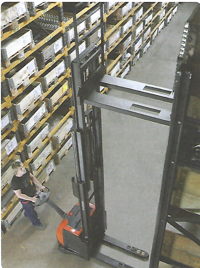
Trucken och lasten har en gemensam tyngdpunkt.
