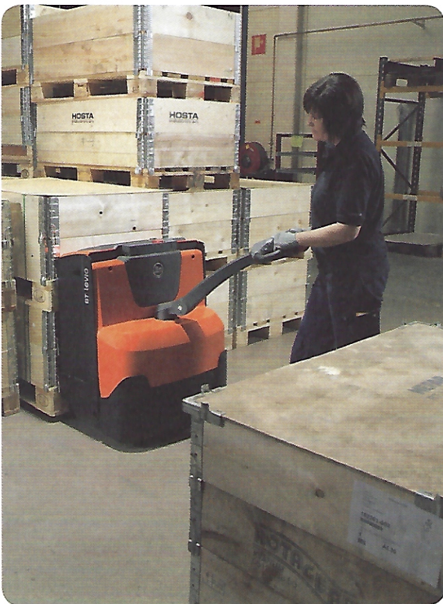
Pallkragen är ca 200 mm hög och kan byggas upp på höjden. Den används ofta ihop med EUR-pallen.
